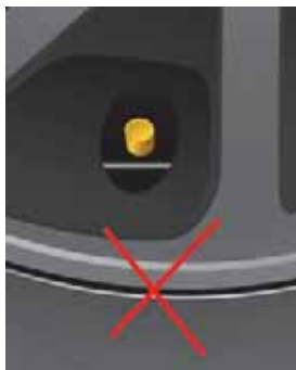
Неправильное положение края декоративного колпака.
