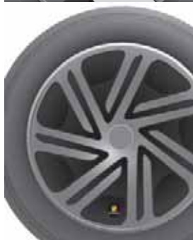
Неправильное положение края декоративного колпака.
